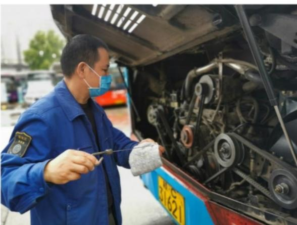
进入春运，客流增大，公交车运输繁忙。为切实做好车辆春运安全检测工作，在不影响正常营运秩序的情况下，公交集团精心组织，合理安排，调配车辆逐台上检测线进行检测，检查内容包括发动机、动力电池、悬挂、灯光电气、轮胎、油箱（气瓶）等，每辆车必须上检测线进行制动性能安全检测。在检查中，发现存在问题的，限期整改修复，彻底消除安全隐患，严禁技术状况不达标的车辆参加春运。检查实行“谁检查、谁签字、谁负责”的原则，检查结果由车属单位分管领导和检查人员签字确认。
